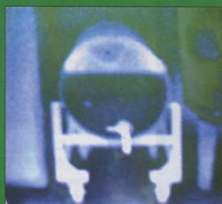
Füllstandskontrolle: Mit Hilfe der Wärmebildkamera lässt sich der Füllstand von Fässern, Tanks oder Kesselwagen genau überwachen.
