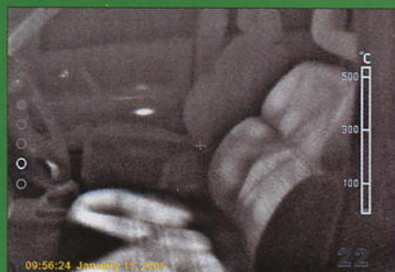
Verkehrsunfall: Das Wärmebild einer Sitzfläche des Fahrersitzes, auf der zu erkennen ist, dass dort eine Person gesessen hat. Ein Beifahrer war nicht im Fahrzeug.
