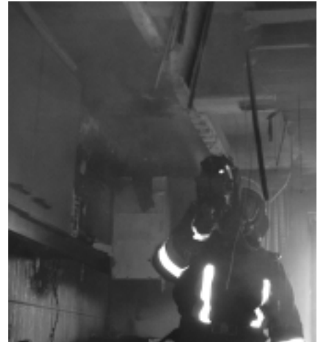
Atemschutzträger der Freiwilligen Feuerwehr Schöllnach benutzen die Wärmebildkamera Bullard Tlx, um versteckte Glutnester aufzuspüren.
