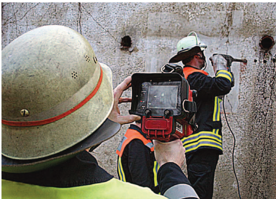
„Mit der WBK konnte der Brandherd in der Wand genau lokalisiert werden“
