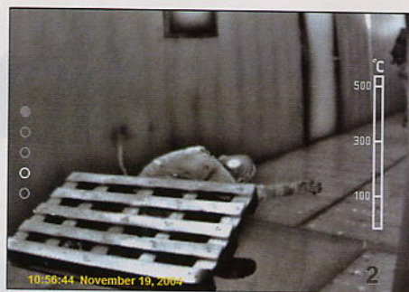
Sichtbar: Mit der Wärmebildkamera können auch versteckte Personen gesehen werden.
