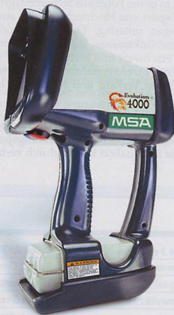
Auslaufmodelle: Die Cairns Viper von Rosenbauer und die Evolution 4000 von MSA Auer waren die letzten großen VOx-Kameras mit Mikrobolometer-Technologie auf dem deutschen Markt.
